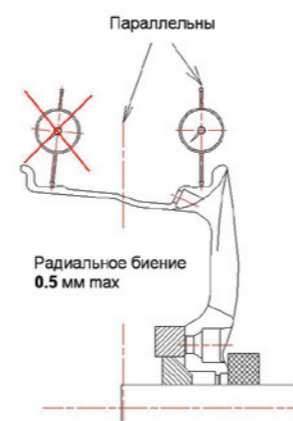
Рис. 6 Правильная и не правильная установка индикатора при проверке радиального биения колеса
