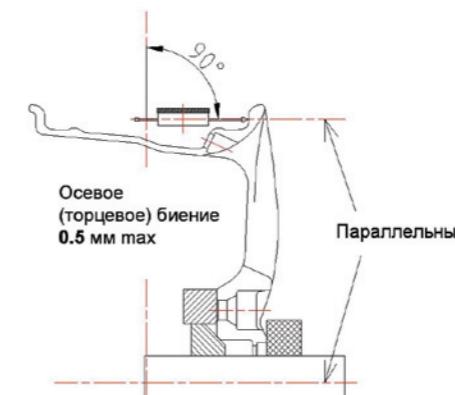
Рис. 7 Проверка осевого (торцевого) биения колеса
